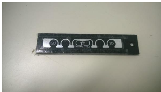
Figura 3 Etiqueta RFID (TAG) Impinj modelo Monza 4. Fonte: Do autor.
