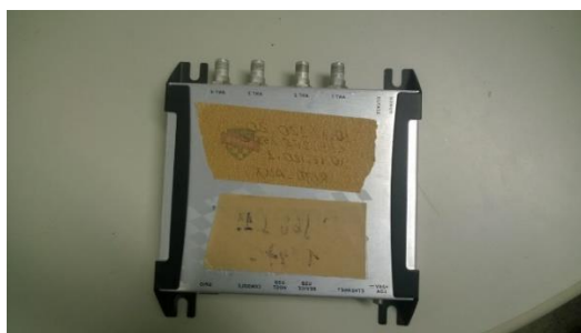
Figura 1 Leitor RDIF Impinj modelo Speedway Revolution R420. Fonte: Do autor.
