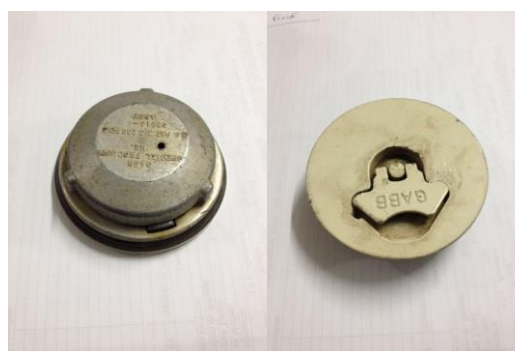
Figura 3 – Tampa tanque de asa
