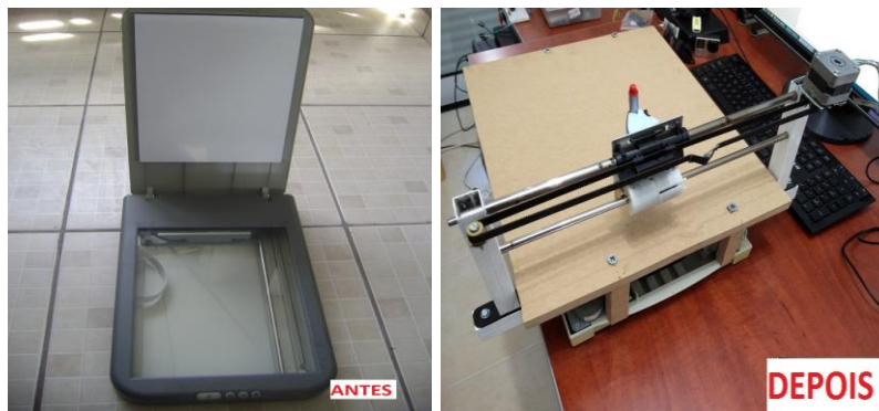
Figura 02: Aplicação de retrofit em um dispositivo de saída (escâner).
